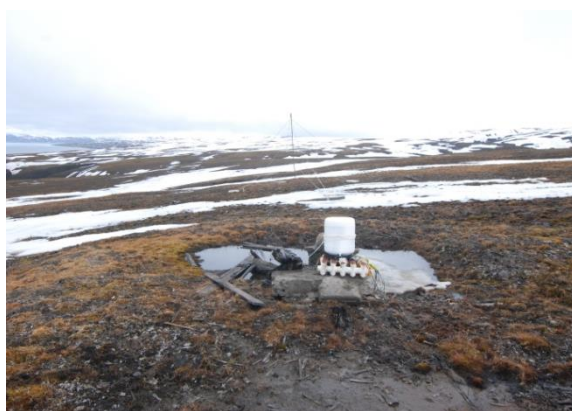
Provisorisk antenne forankring
