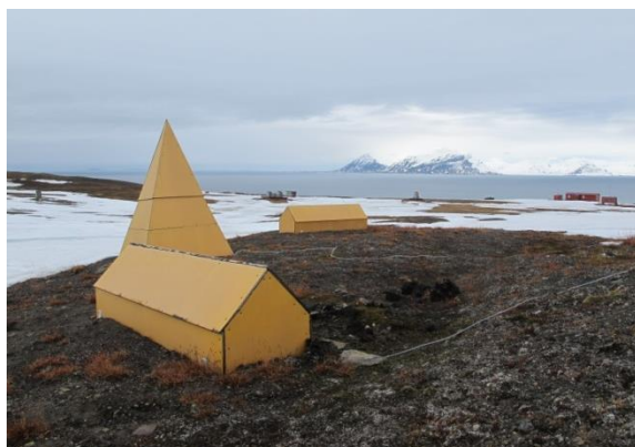
Kassene inneholder induksjonsgivere som måler magnetiske kraftfelt
