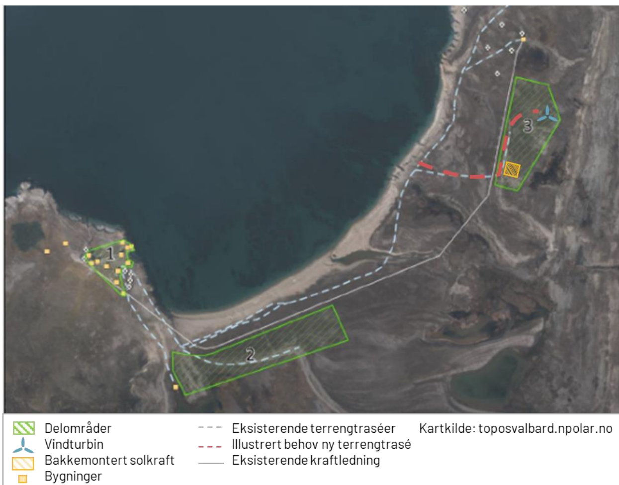
Figur 2: Illustrasjon av plassering av ca. 80 kWp bakkemonterte solceller og én vindturbin på område 3. Endelig plassering av turbin, solceller og ny terrengtrasé avgjøres etter nærmere grunnundersøkelser og i samråd med reguleringsmyndighet.
