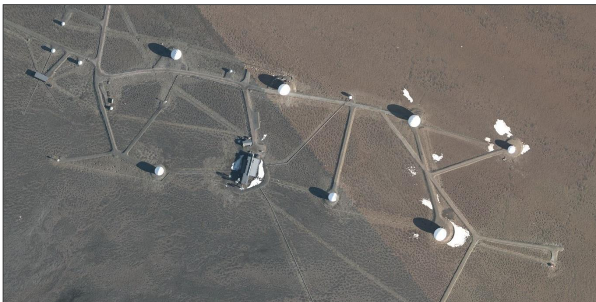
Figur 9-20. Ortofoto fra TopoSvalbard viser at det ved dagens anlegg er utført inngrep i terrenget på kryss og tvers utenfor eksisterende veilinjer. Dette bør unngås i fremtiden.
